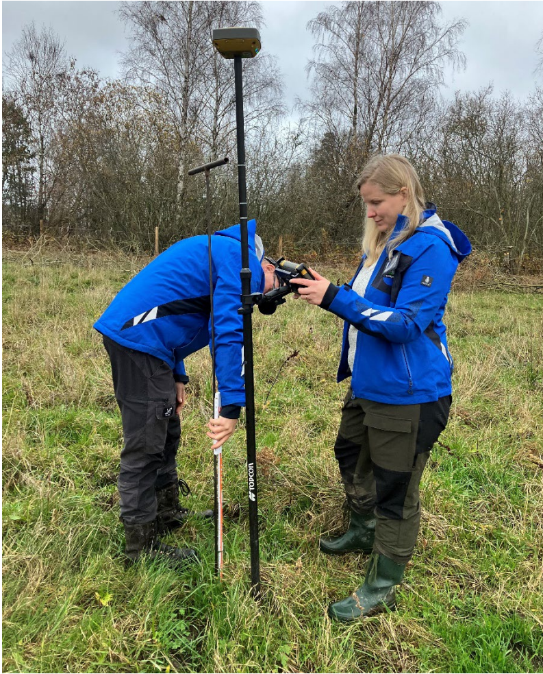
Figur 5. Mätning av matjordsdjup med järnlinjal och inmätning av kalibreringslinjer till nationella höjdmodellen. November 2022. Foto: Lisa Andersson
